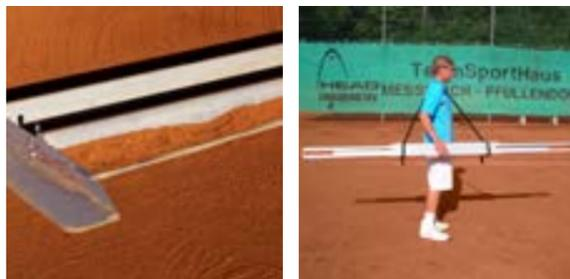
Wenn man den fast 2.5 m breiten Court Fix gleitend über den frisch eingebrachten Sand zieht, **wird der erhöhte Tennissand zwischen den zwei Gleitauflagen als Überschuss solange vor der Abziehschiene mit sich gezogen, bis es die kommenden Senken oder Mulden damit füllt.**
