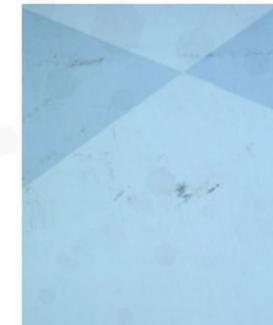
Die Laykold-Masters-Oberflächen sind widerstandsfähig gegenüber normalem Schlägerkontakt. Jedoch können starke Schläge mit Metallschlägern in einem spitzen Winkel auf die Oberfläche leichte Kratzer verursachen. Diese Schäden beschränken sich normalerweise auf die oberen Schichten und können einfach repariert werden. In diesem Fall sollte die Fehlstelle von einem Laykold-Fachbetrieb ausgebessert werden.
