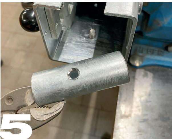
**Gebohrtes Rohr mit Loch rausziehen**
