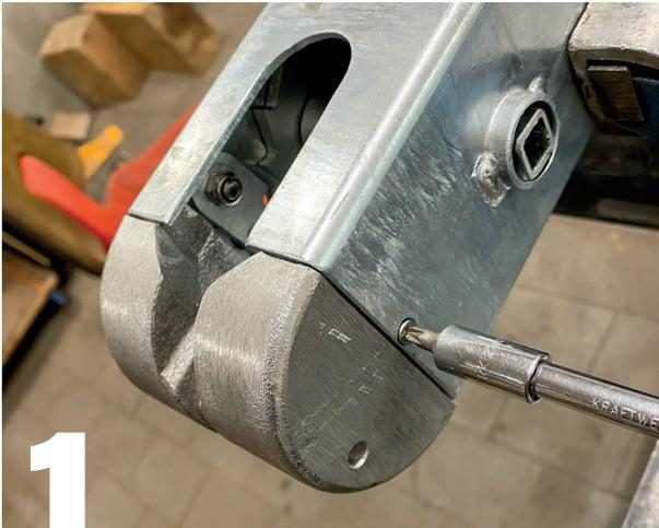
**2x Kreuzschrauben herausdrehen um Deckel zu entfernen**
